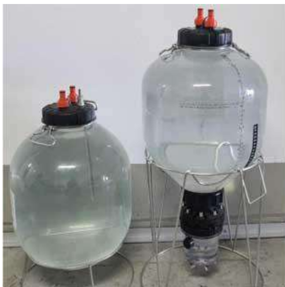
All Rounder 30 л и ЦКТ/Unitank 27 л без избыточного давления (0 атм), до начала проведения
