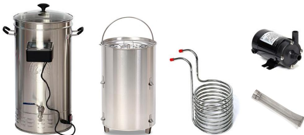
**Варочная ёмкость** включает в себя нагревательные элементы, расположенные в основании. К ней присоединяется электронный программируемый контроллер для управления температурой, мощностью нагрева и длительностью каждого шага программы. Варочная ёмкость используется в ходе всего варочного процесса: при нагреве воды для заторения, в процессе фильтрации, кипячения и охлаждения пивного сусла, которое затем переливается в ёмкость для сбраживания.
