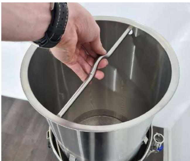
Корзина оборудована двумя рядами удерживающих скоб – внизу и посередине. Подъём тяжёлой корзины из жидкости можно осуществлять в два подхода, вынимая её из пивоварни либо только наполовину, либо полностью - это значительно облегчает процесс.
