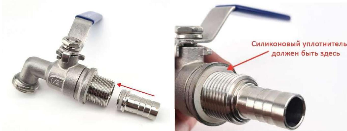
Переверните пивоварню вверх дном и вставьте штуцер крана в отверстие в стенке котла. Закрепите кран с внутренней стороны с помощью шестигранной гайки, затем с помощью стопорной гайки закрепите штуцер в кране.
