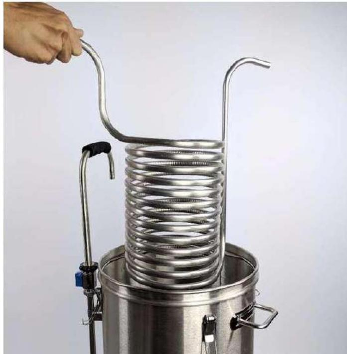
Вода подводится в чиллер с помощью шланга. Для закрепления шланга на кране используйте переходник на кран/штуцер для смесителя. Переходник подбирается в соответствии с резьбой на кране (с внутренней резьбой арт. 6592, с наружной резьбой арт. 4088, универсальный арт. 5737). На штуцер на кране натягивается один конец шланга, второй конец этого шланга натягивается на трубку змеевика. Для отвода воды из чиллера на его вторую трубку натягивается другой шланг, его конец помещают в раковину или ванну.
