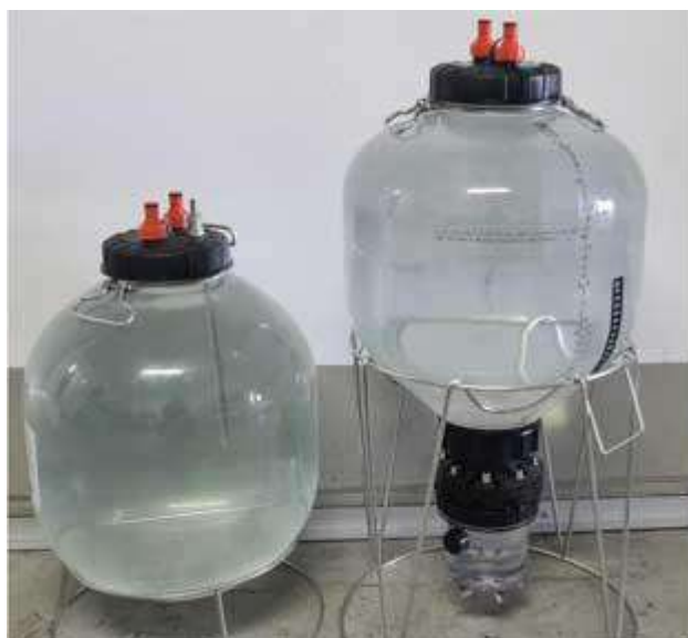
All Rounder 30 л и ЦКТ/Unitank 27 л без избыточного давления (0 атм), до начала проведения гидротестирования
