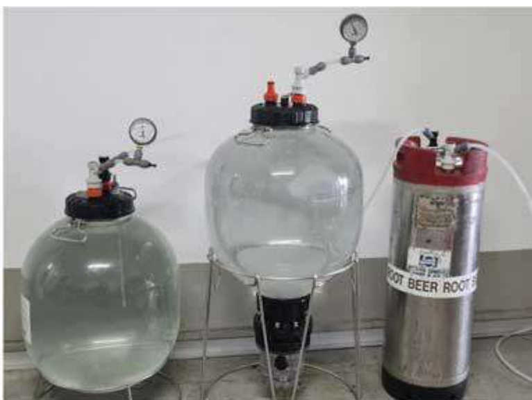
В ферментерах All Rounder 30 л и ЦКТ/Unitank 27 л повышенное давление – 4,5 атм. Во время гидротестирования
