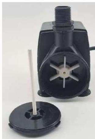
Шаг 4. Вытащите крыльчатку из гнезда. Будьте аккуратны, вытаскивая крыльчатку — в насос установлен довольно сильный магнит, он может довольно сильно и резко потянуть крыльчатку обратно.
