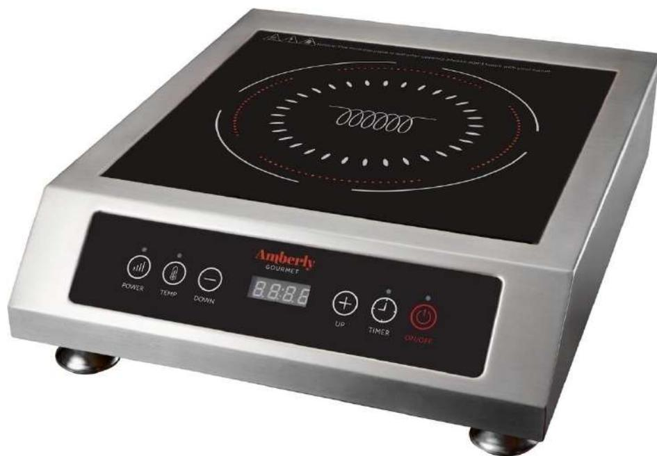
Плита индукционная профессиональная настольная. Металлический корпус, поверхность из стеклокерамики. В верхней части плиты расположена индукционная конфорка, на которую устанавливается посуда. Диаметр дна посуды должен быть не меньше 12 см. Плита способна выдержать вес до 100 кг при условии, что диаметр посуды не менее 36 см. Максимальная мощность нагрева – 3,5 кВт.
