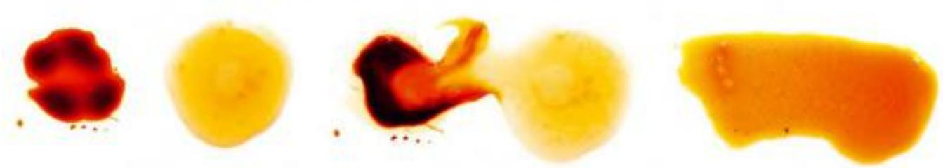
ФОТО 5. Для того чтобы проверить, весь ли крахмал расщеплен на сахара, обычно используют простейшую йодную пробу. Если при соединении капли сусле с каплей йода не происходит окрашивания в синий цвет, значит, крахмала в сусле больше не осталось
