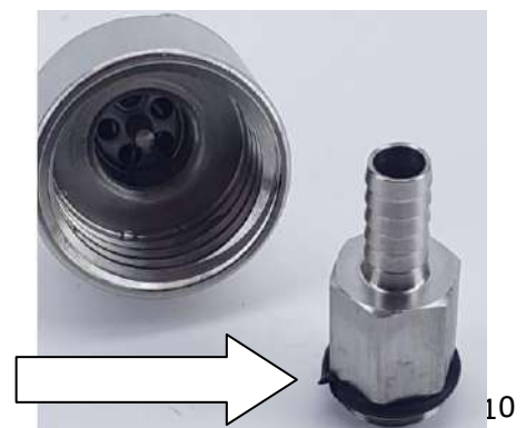
Повреждённое уплотнительное кольцо
